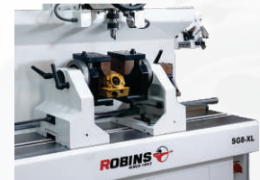
Mini Cylinder Head Machining on SG8XL
